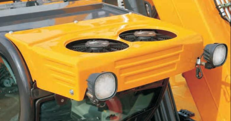
Полуавтоматическая система кондиционирования с 7-ю вентиляционными воздуховодами, позволяет создать идеальную циркуляцию воздуха в салоне. Открытие верхнего люка кабины и заднего стекла во всех моделях позволяет обеспечить отличную вентиляцию во время работы.
