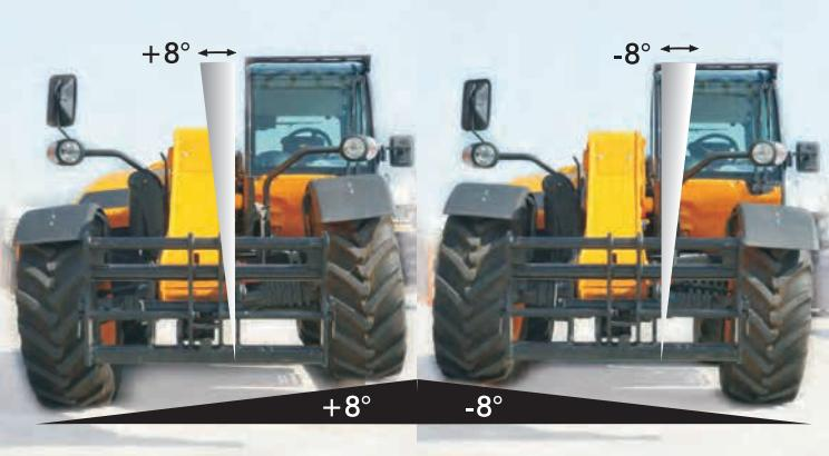
Устройство поперечного выравнивания (опционально) с возможностью наклона до  $\pm 8^\circ$  позволяет работать в полной безопасности на неровных поверхностях.
