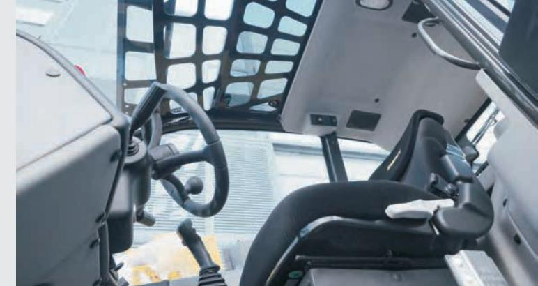
Кабина стандарта ROPS-FOPS разработана с учетом всех требований по безопасности для предотвращения повреждений при падении груза.
